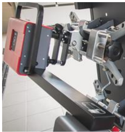
Głowica pomiarowa z kompensatorem i uchwytem na koło
